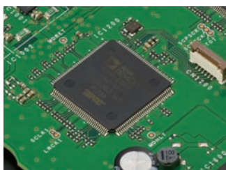
For IF DSP, transmitter ADSP-21363 clock @332MHz
